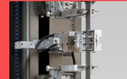
**CWA 15261-2:2005 *Measurement uncertainties in mechanical tests on metallic materials — The evaluation of uncertainties in tensile testing*** beschreibt die Einflüsse der Messsysteme auf die Kennwerte im Metallzugversuch.
