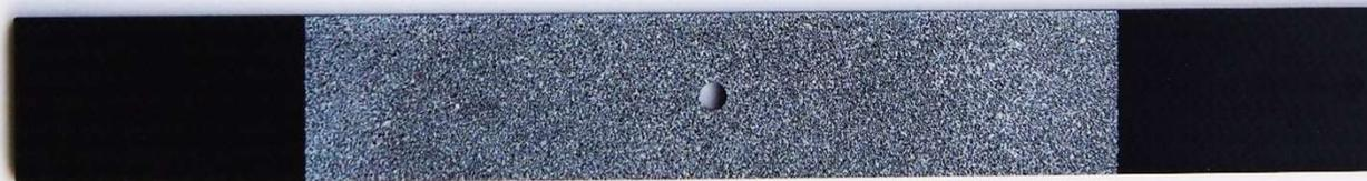
Iosipescu Schubversuch nach ASTM D5379
