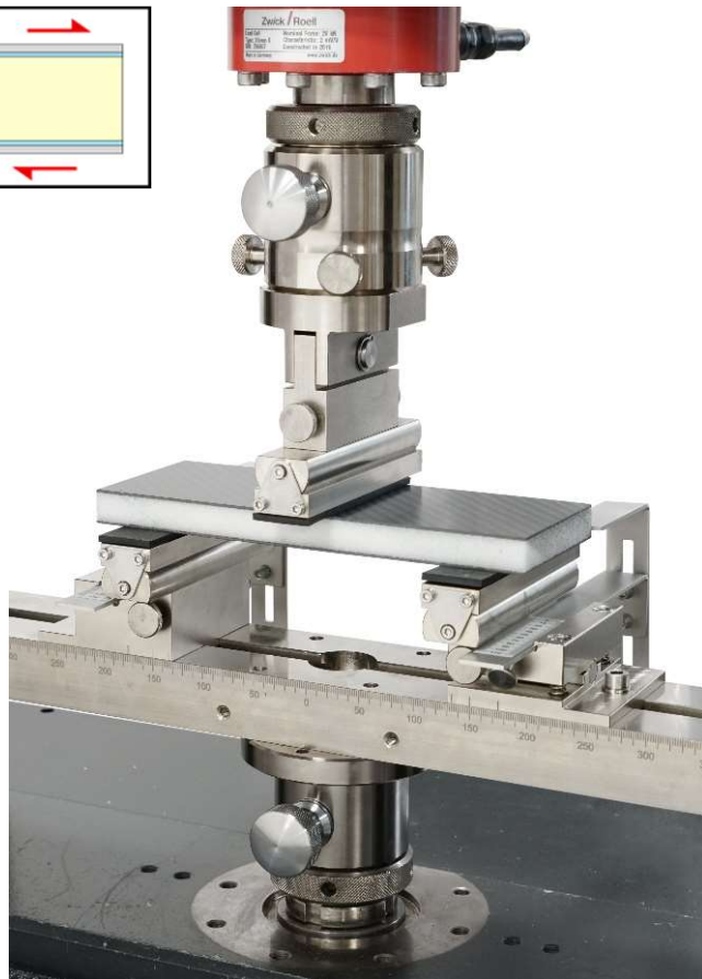
Standard 3-Punkt Biegeversuchsaufbau nach ASTM C 393
