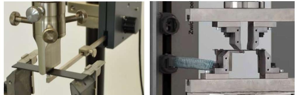
Wegmessung mit Biegeaufnehmer (links) oder mit makroXtens und Fühlerarm für Biegeversuche...
