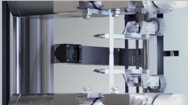
makroXtens / multiXtens & videoXtens Breitenänderungsaufnehmer T-40 HP
