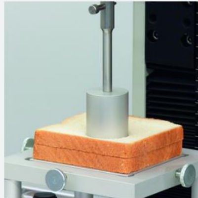
Spezial-Stempel: Festigkeit von Brot nach AACC, Bloom-Härte
