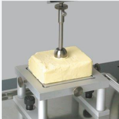
Eindringstempel zur Bestimmung der Härte von Lebensmitteln
