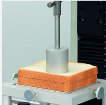
Spezial-Stempel: Festigkeit von Brot nach AACC, Bloom-Härte
