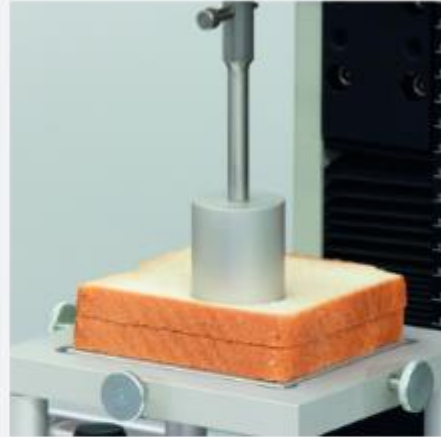
Spezial-Stempel: Festigkeit von Brot nach AACC, Bloom-Härte
