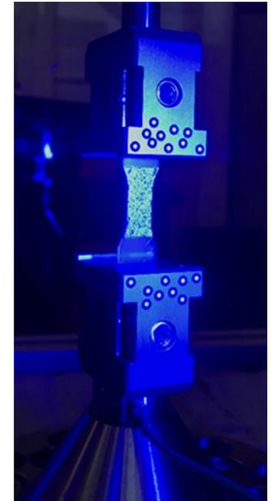
Dehnraten bis ca.  $150 \text{ s}^{-1}$  sind mit üblichen Prüfmitteln realisierbar
