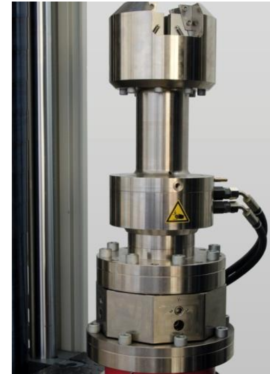
Symmetrisch und parallellspannende Backen, ohne Bedienerinfluss
