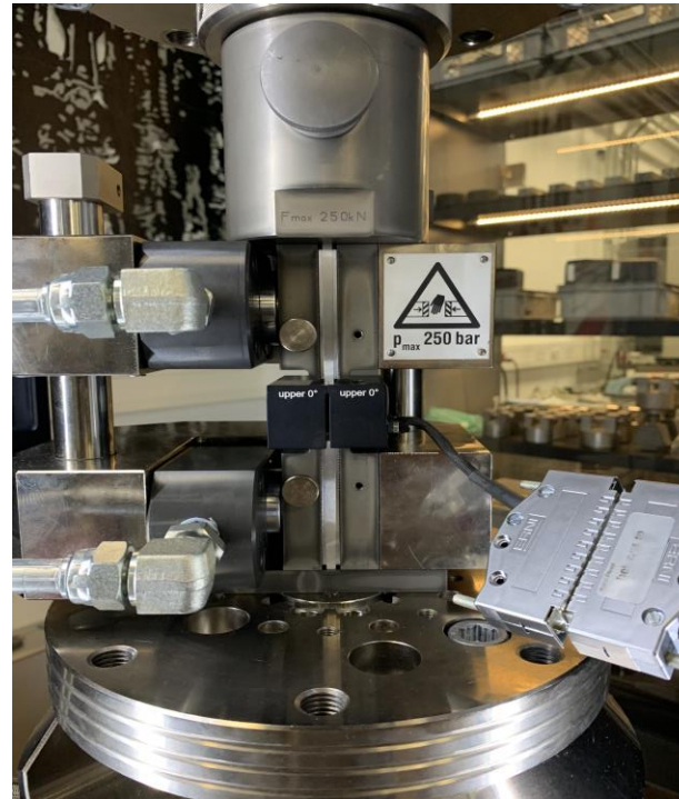
HCCF Vorrichtung mit Messnormal (unkritisch auch in Temperiereinrichtungen) (kurze Hebel)
