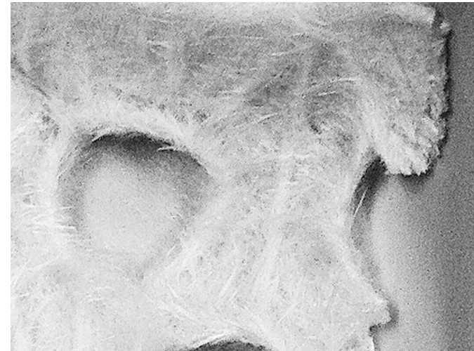
Teil eines seat bracket für deutschen OEM nach Verbrennung
