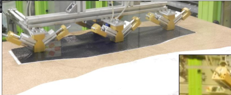
Aufnahme des Sensorvlieses mittels Handlingsystems
