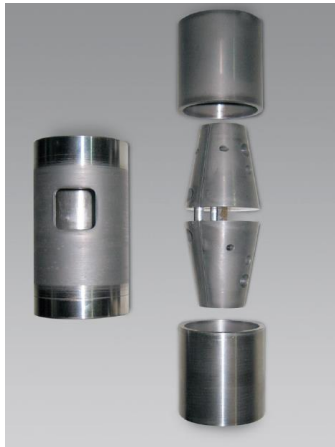
Die alte ASTM D 3410 Einrichtung war noch mit konischen Spannkörpern ausgestattet und empfindlich auf die Probendicke und Torsion.
