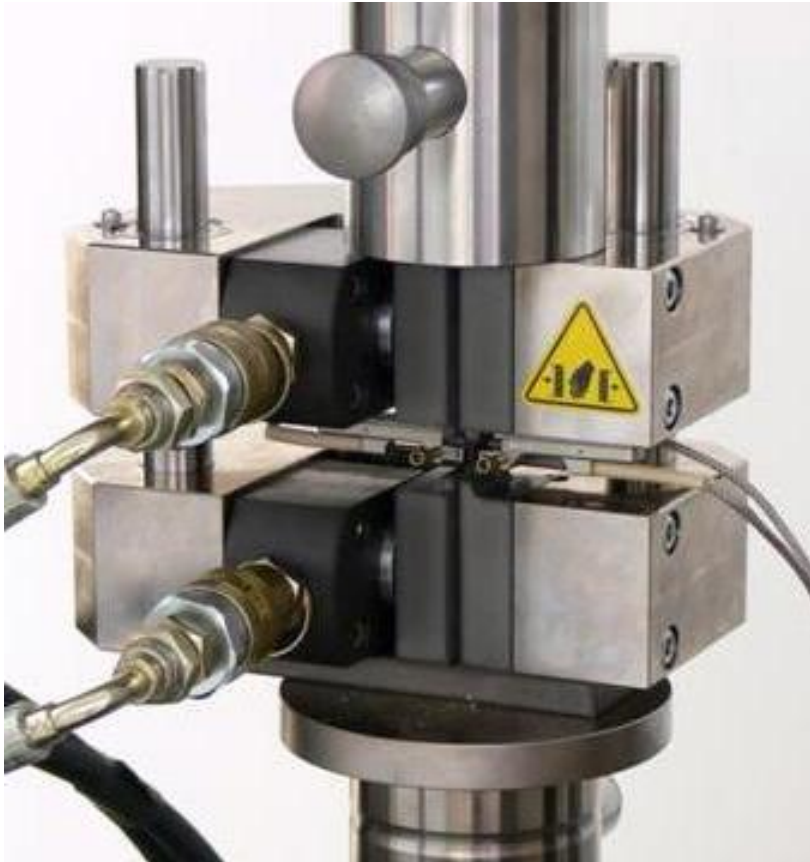
Beidseitig messender Ansetzaufnehmer in einem speziellen Halterahmen.
