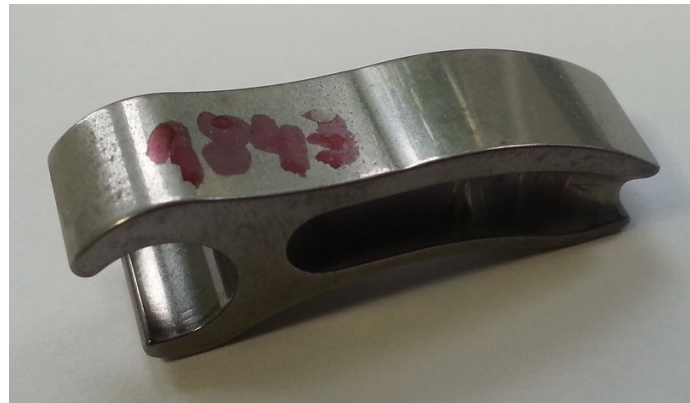
Schlepphebel (CrN +DLC beschichtet)
