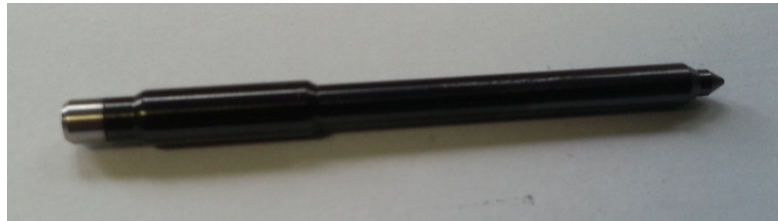
Einspritznadel von Dieselmotoren (DLC beschichtet)
