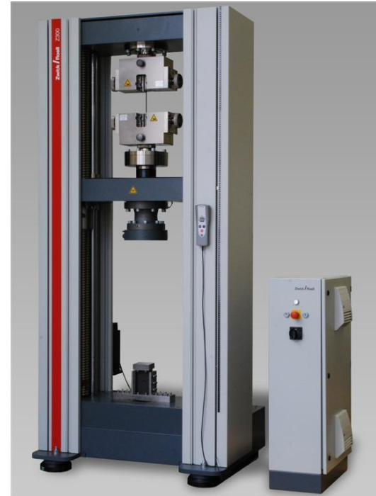
Eine Serie sorgfältig vorgeschädigter Probekörper wird danach in einer speziellen Druckeinrichtung geprüft und so der Festigkeitsverlust festgestellt.
