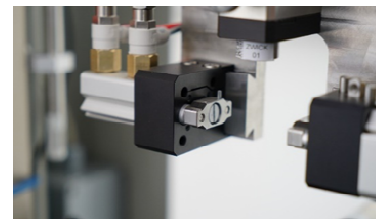
Vertauschungssichere Platzierung von Klemmbacken mittels Poke Yoke Prinzip
