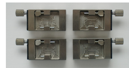
Vertauschungssichere Platzierung von Klemmbacken mittels Poke Yoke Prinzip
