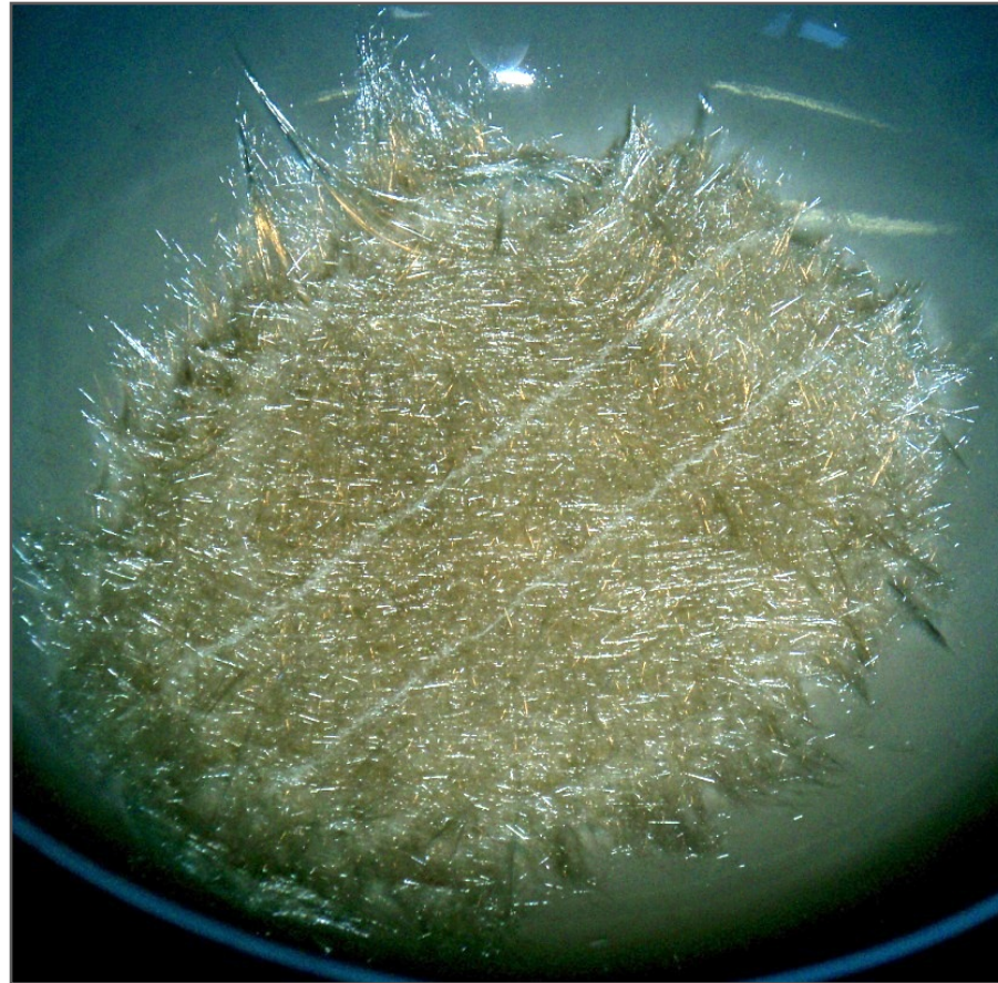
„AOI“ nach Verbrennung: unzerstörte Fasern im Randbereich
