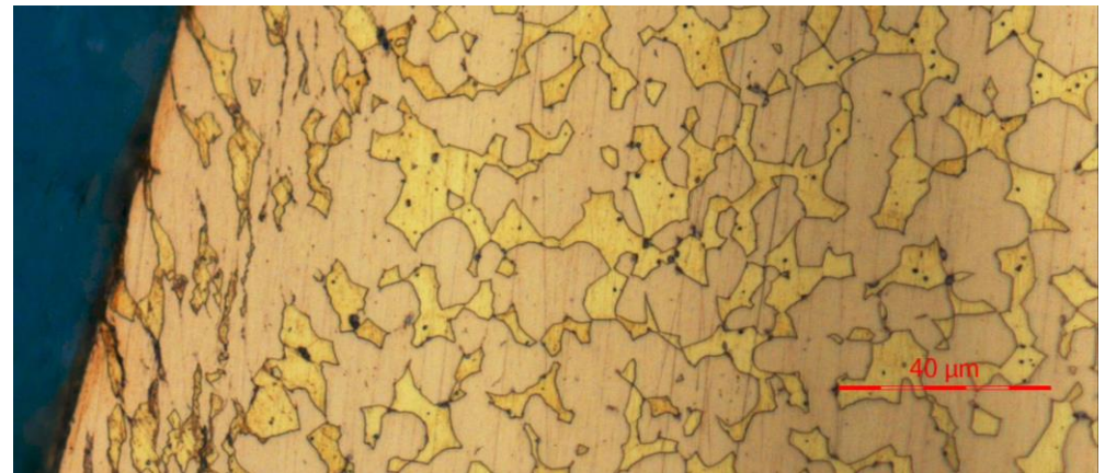
Gewindelängsschliff eines Fittings aus CuZn39Pb3: durch spanende Bearbeitung eingebrachte Randaufhärtung (=Verformung)
