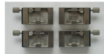
Vertauschungssichere Platzierung von Klemmblocken mittels Poka Yoke Prinzip
