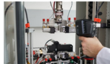
Eindeutige Kennzeichnungen und Prüfstartfreigabe nach pos. Scan
