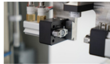
Vertauschungssichere Platzierung von Klemmblocken mittels Poka Yoke Prinzip
