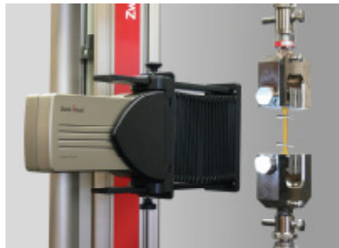
Genauigkeitsanforderung der ISO 527 Bezüglich E-Modul-Bestimmung
