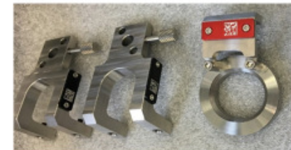
Eindeutige Kennzeichnungen und Prüfstartfreigabe nach pos. Scan
