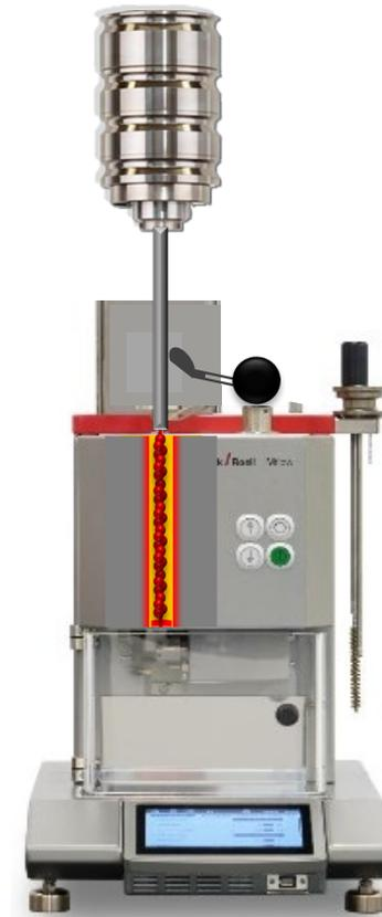
Die Schmelze-Massefließrate wird aus dem Gewicht der Strangabschnitte bestimmt.
