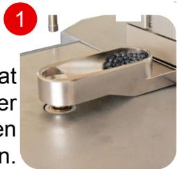
Füllen Sie das Granulat einfach und schnell über den selbstzentrierenden Trichter ein.
