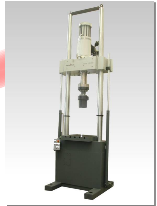
Standmodelle HB, Nennlasten von 50 bis 2500 kN.
