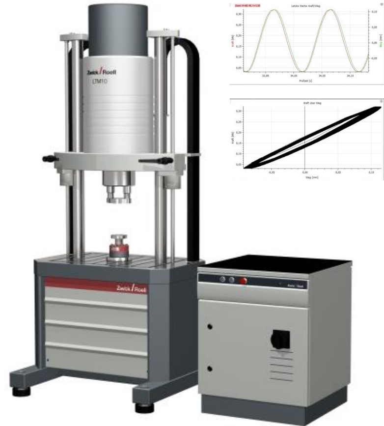
LTM 10 – Dynamisch mit elektrischem Antrieb
