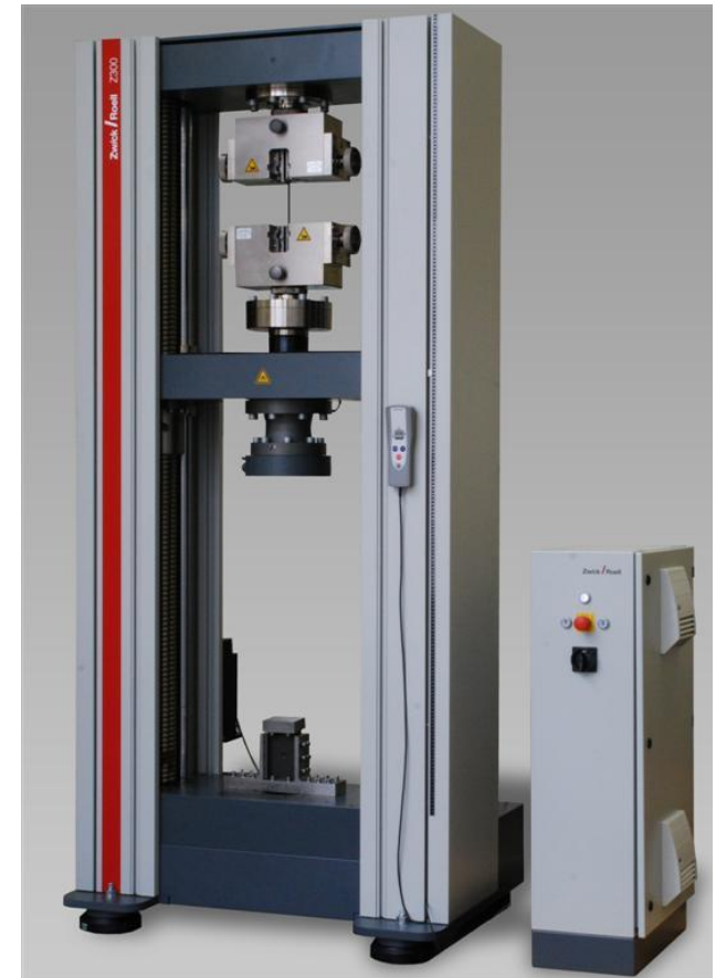
Nennlasten bis 1000 kN mit elektromechanischen Antrieben
