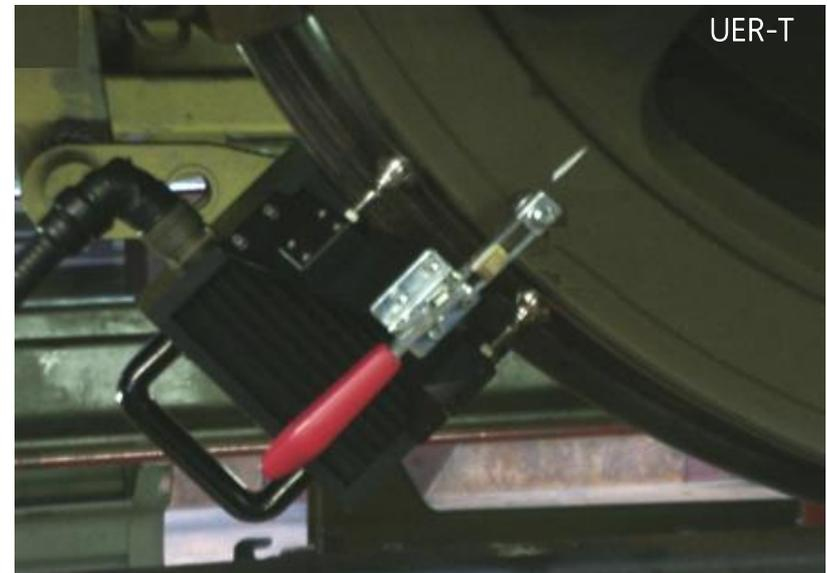
Mobiles Eigenspannungs-Messgerät für Eisenbahnräder
