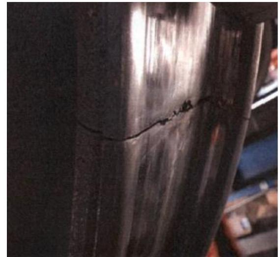
Risse in Eisenbahnradern unter der Wirkung von Eigenspannungen
