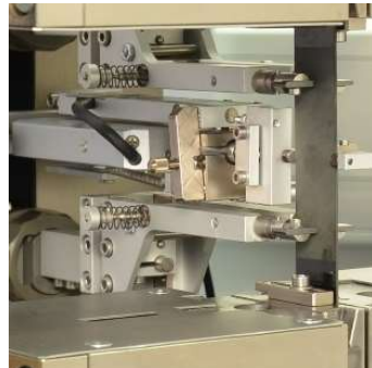
In-Plane-Shear ( \pm 45^\circ )
