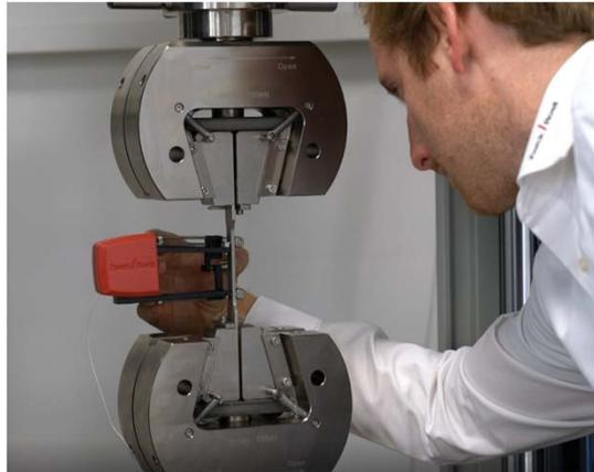
Mit nur einer Hand kann der Clip-On Ansetzaufnehmer sicher und schnell an die Probe angesetzt werden
