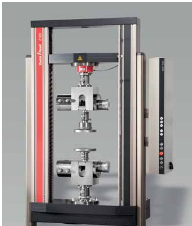
Bild 1: Die testControl II setzt neue Maßstäbe in der Mess-, Steuer- und Regeltechnik für Prüfmaschinen
