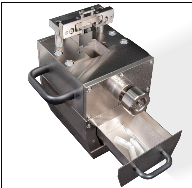
Izod-Prüfwerkzeug mit Schublade für Probenreste
