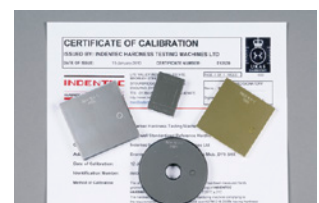
Härtevergleichsplatte mit Zertifikat
