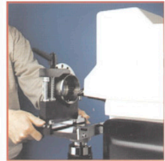
Vorbereitung zur Innenmessung eines Getriebeteils
